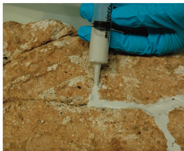
Fig. 4. Tratamiento del reverso mediante inyección de mortero sintético inerte, para conferir estabilidad a la adhesión de los fragmentos.
