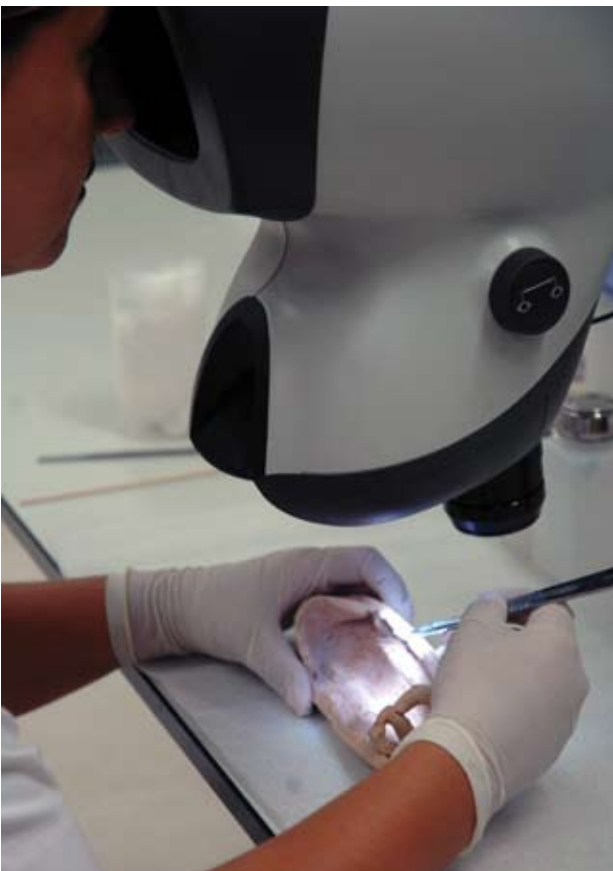
Figura 4. Limpiezas físico-química y mecánica bajo lupa binocular.
