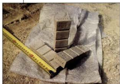
Elementos indicadores (testigo cerámico y fibra geotextil)
