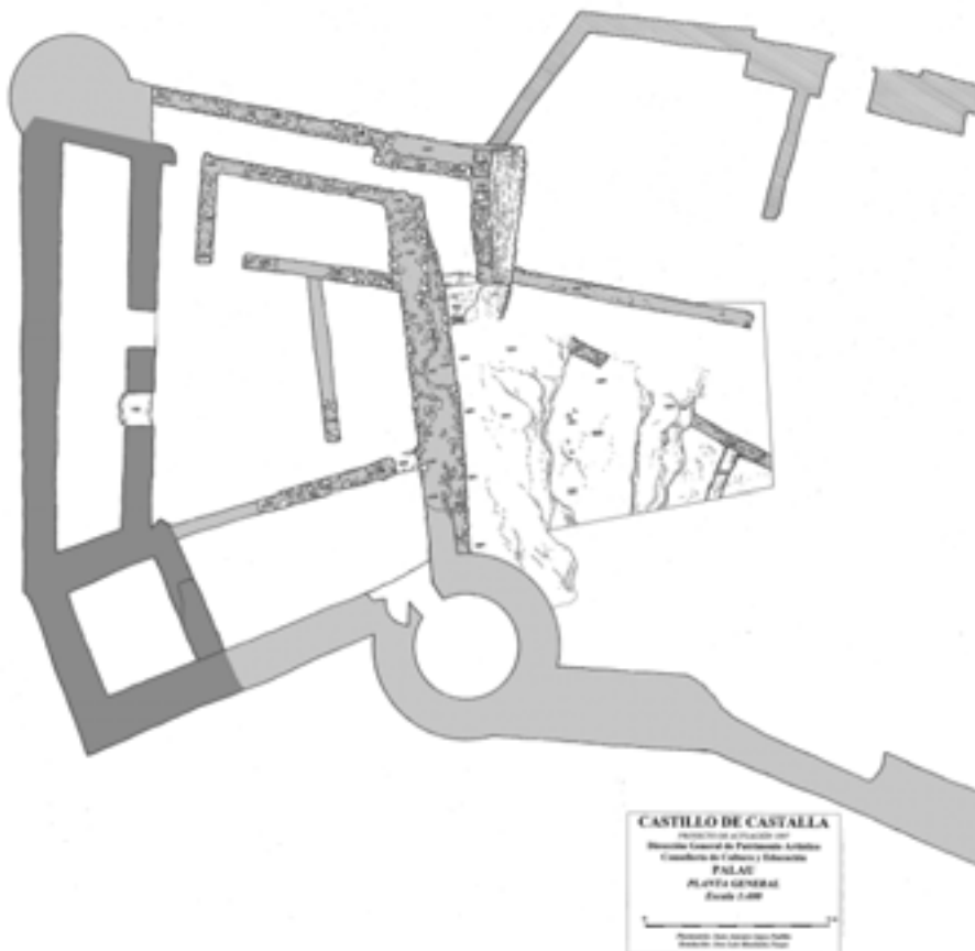
Figura 2.7. Fases de construcción de la domum maiorem a la vista de los restos arqueológicos.
