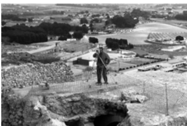
Figura 3.5. Trabajos de topografía para obtener la planimetría de las excavaciones. Marzo 1999.
