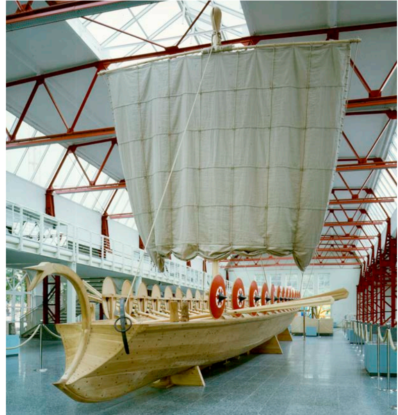
23 a-b COPIA A TAMAÑO ORIGINAL Y RÉPLICA de un barco tardorromano (Tipo A) basada en la reconstrucción de los buques hundidos 1 y 5 hallados en Maguncia y que datan de finales del siglo IV. Römisch Germanisches Zentralmuseum Mainz .
