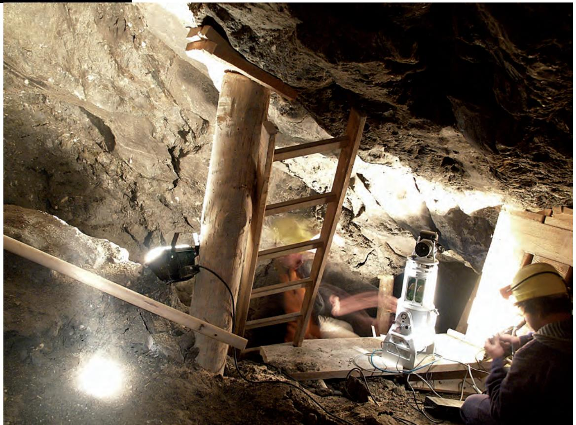
Documentación de una cámara minera en *Grünerwerk* mediante un escáner láser 3D.
