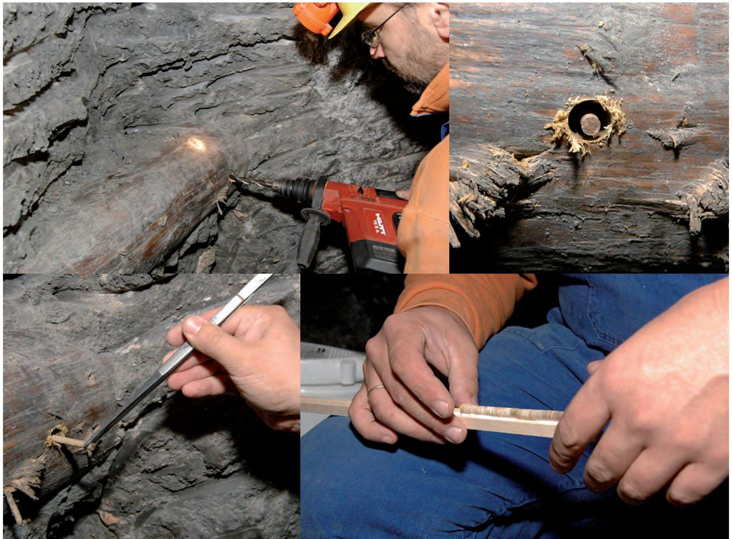
Muestreo de madera prehistórica en *Christian von Tuschwerk*. Se utiliza una broca hueca para extraer un fragmento que se fija a un soporte y se lija convenientemente.
