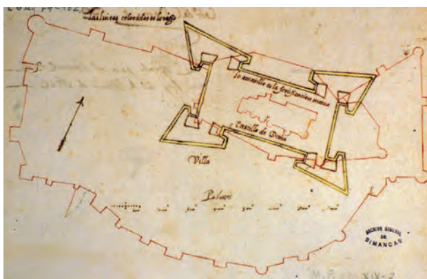
Figura 5.93: Planta del recinto fortificado de la Villa de Denia y del castillo de la misma en la forma antigua y nueva que se propone por Vespasiano Gonzaga. Año 1575. Archivo General de Simancas.
