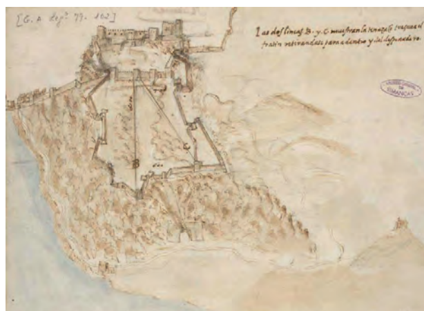
Figura 5.36: Perspectiva del Castillo de Alicante con las nuevas obras de fortificación que se ponen para su mejor defensa, posiblemente trazadas por el ingeniero Giovanni Battista Antonelli il Vecchio Año 1575. Archivo General de Simancas.
