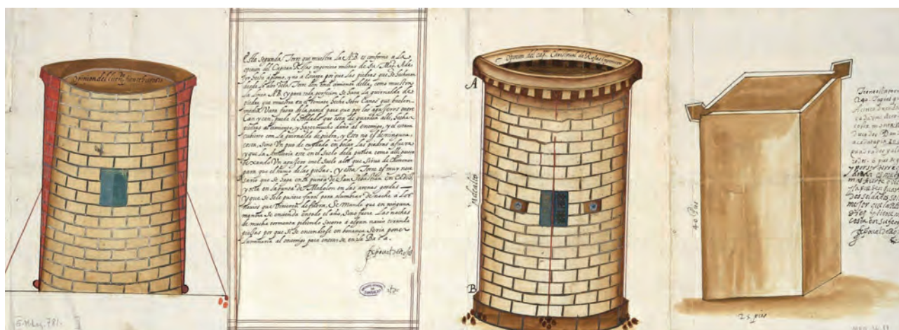
Figura 4.8: Diseño de tres torres para la defensa del litoral de Andalucía por el ingeniero Cristóbal de Rojas. Año 1616. Archivo General de Simancas.
