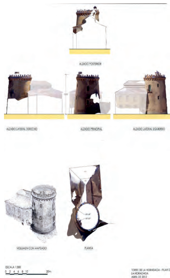
Figura 6.4: Plantas y alzados con fotogrametría y reconstrucción volumétrica de la Torre de la Horadada. Autor: Oscar Lerma., Escuela Técnica Superior de Ingeniería de Edificación, Universitat Politècnica de Valencia.
