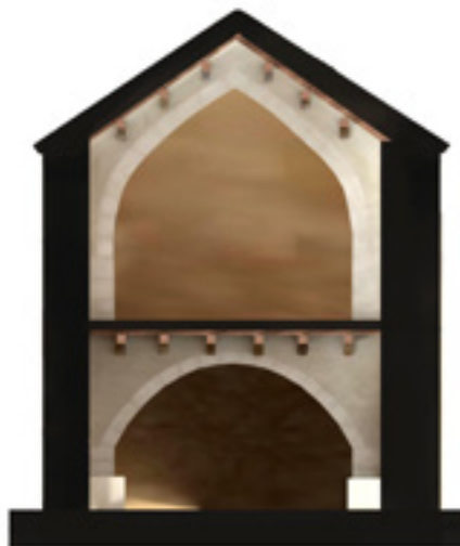
Figura nº 121: Restitución en sección de las plantas y cubiertas de la Domus Llúria de Ifach. Dibujo: Pilar Mas Hurtuna. Archivo Gráfico MARQ.
