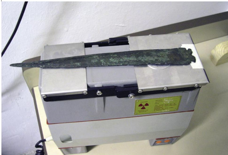
Figura 2. SSPS1 del espectrómetro Metorex XMET920 dispuesto para efectuar el análisis de un puñal de la Edad del Bronce.
